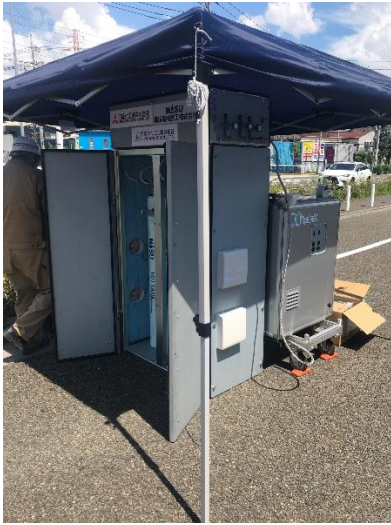
水素吸蔵合金ユニットと可搬型燃料電池システム
