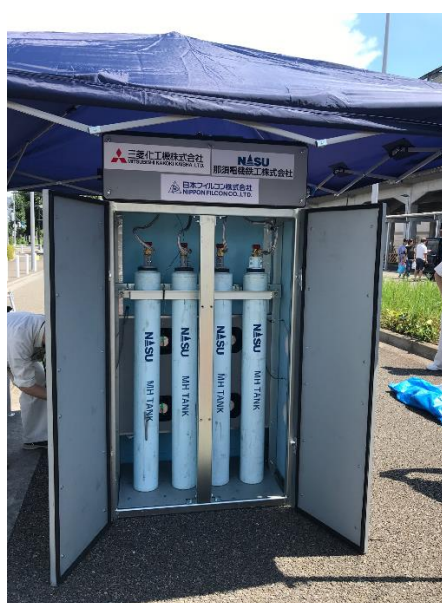
MHタンクをユニットに組み込む作業(左:組み込み中、右:組み込み後)
