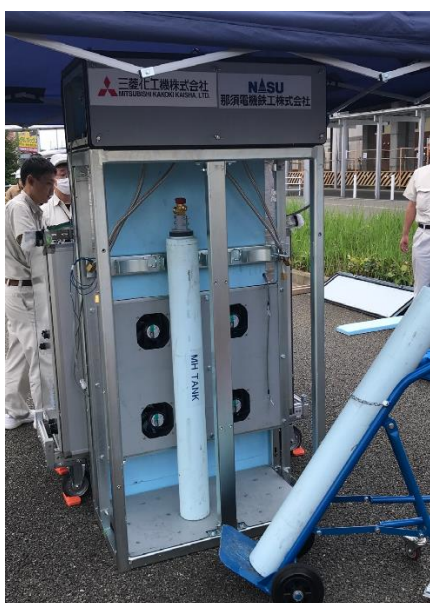
MHタンクをユニットに組み込む作業(左:組み込み中、右:組み込み後)
