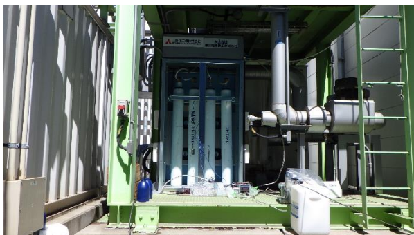
川崎製作所で製造した水素をMHタンクに充填
