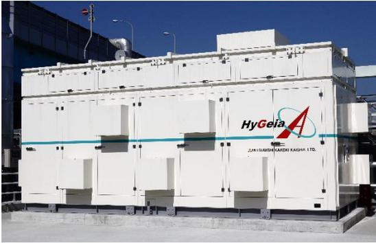
水素の製造と水素吸蔵合金配送システムへの供給を担当します。長年にわたって培ってきた水素製造技術と知見を活かして開発した小型オンサイト水素製造装置「HyGeia（ハイジエイア）」は、高純度の水素をオンサイトで製造・供給することが可能です。今回の実証実験においては、水素製造の原料にカーボンニュートラル
